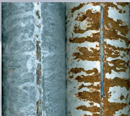
Magnelis® ZM120 soldado, sin protección posterior
